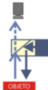
Ilustración 15. Iluminación axial difusa (Bcnvision, 2017)
