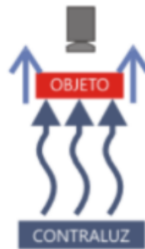
Ilustración 14. Iluminación por contraste (Bcnvision, 2017)
