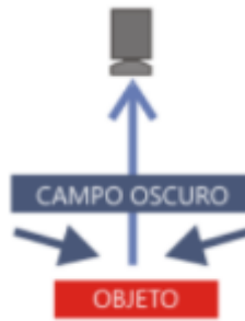
Ilustración 13. Iluminación por campo oscuro (Bcnvision, 2017)
