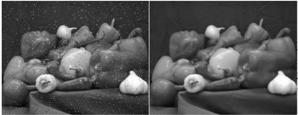
Ilustración 39. Imagen modelo con ruido de impulso / imagen modelo con filtro basado en la mediana
