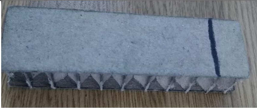
Figura 15 Probeta de cartón para el ensayo de adhesión. (Elaboración: fuente propia)
