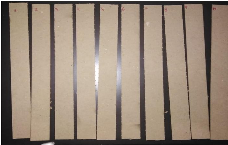
Figura 12 Muestras de prueba de cartón para ensayo de tracción. (Fuente: Elaboración propia)
