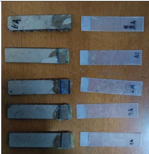
Figura 39 Probetas de adhesión con adhesivo de poliuretano posterior al ensayo de adhesión (Fuente: Elaboración propia)
