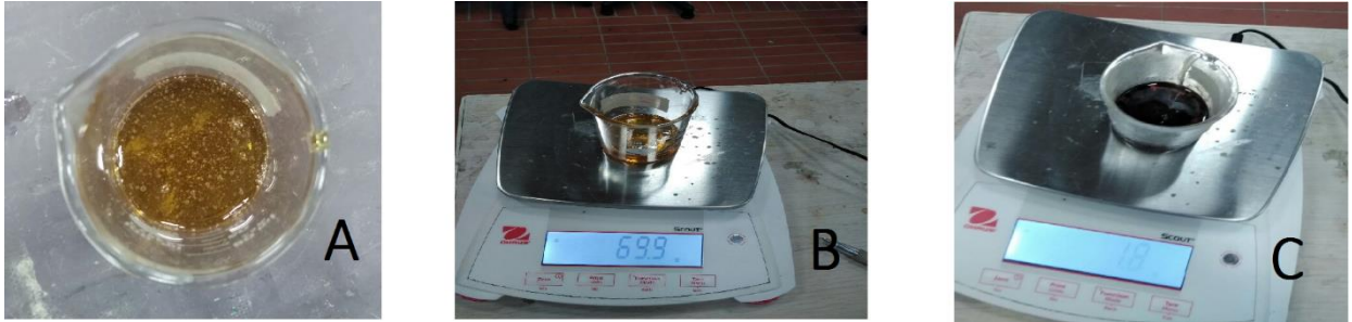
Figura 19a. Resina vinil éster “Derakane 8084”, 19b. Pesaje de la resina vinil Ester, 19c. Resina vinil éster con catalizador y acelerante, (Fuente: Elaboración propia)
