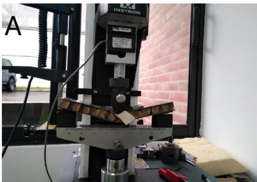
Figura 48a. Ensayo de flexión, 48b. Muestra de prueba posterior al ensayo de flexión. (Fuente: Elaboración propia)
