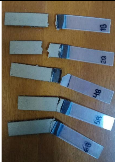
Figura 43 Probetas de adhesión con resina poliéster posterior al ensayo de adhesión (Fuente: Elaboración propia)
