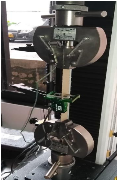
Figura 13 Ensayo de tracción para cartón. (Fuente: Elaboración propia)
