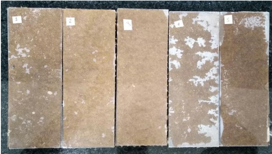
Figura 47 Muestras de prueba con láminas de cartón para el ensayo de flexión. (Fuente: Elaboración propia)
