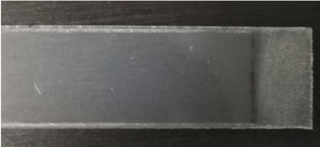
Figura 14 Probeta de polipropileno tratada superficialmente en la zona de unión. (Fuente: Elaboración propia)
