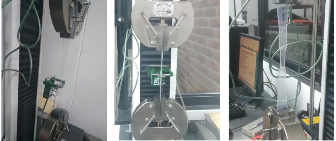
Figura 10 Ensayo de tracción (Fuente: Elaboración propia)
