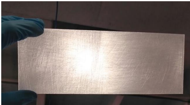
Figura 26 Revestimiento de muestra de prueba para ensayos de flexión posterior al tratamiento superficial. (Fuente: Elaboración propia)
