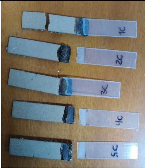
Figura 41 Probetas de adhesión con resina vinil éster posterior al ensayo de adhesión (Fuente: Elaboración propia)
