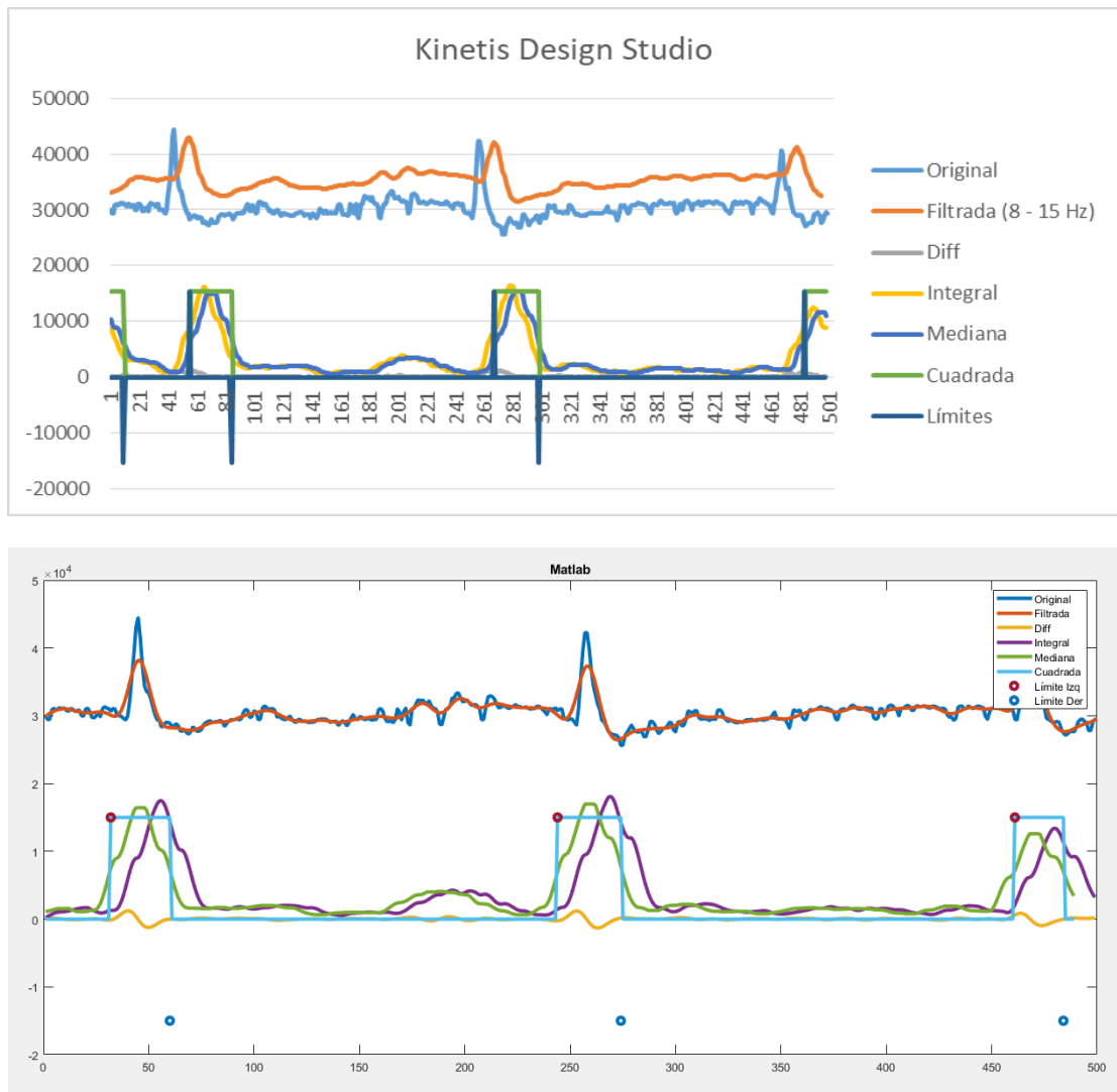
Figura 3.17 Comparación entre los resultados obtenidos con Kinetis Design Studio (arriba) y Matlab (abajo).
