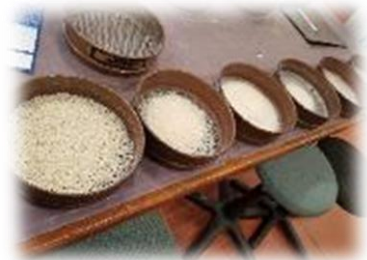
d). Tamices para ensayo de granulometría
