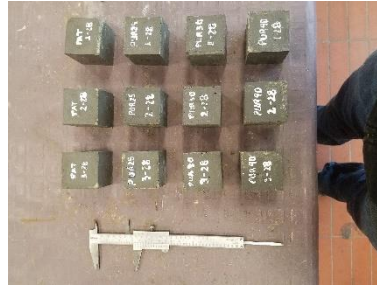
Figura 11. Muestras geopoliméricas para su dimensionamiento con pie de rey
