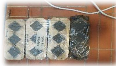
d). Probetas rotuladas envueltas en Vinipel listas para el curado
