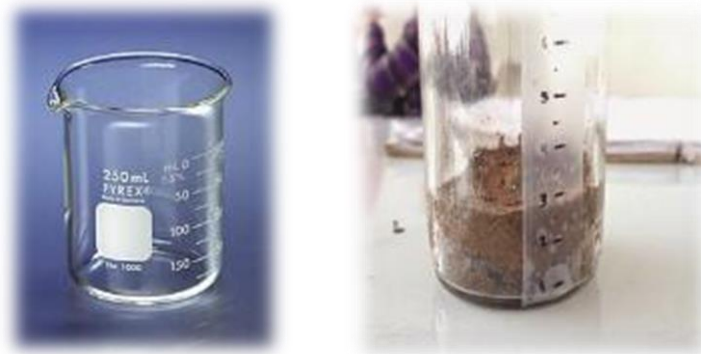
Figura 6. Arena sin compactar en Beaker de volumen conocido. Imagen tomada de tecnoedificacion2014
