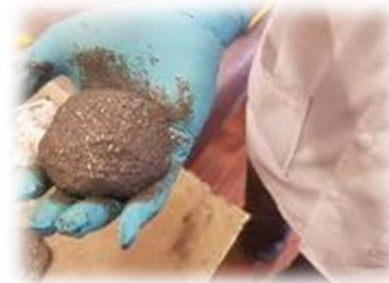
j). Preparación de la mezcla geopolimérica
