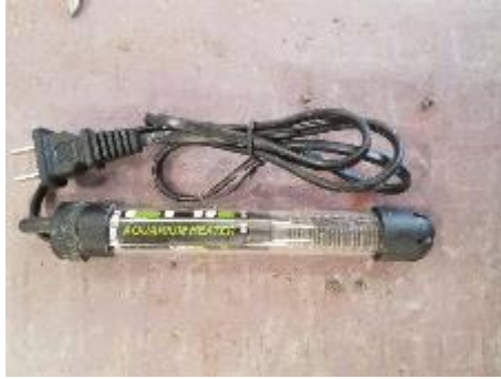
Figura 12. Resistencia para curado en agua
