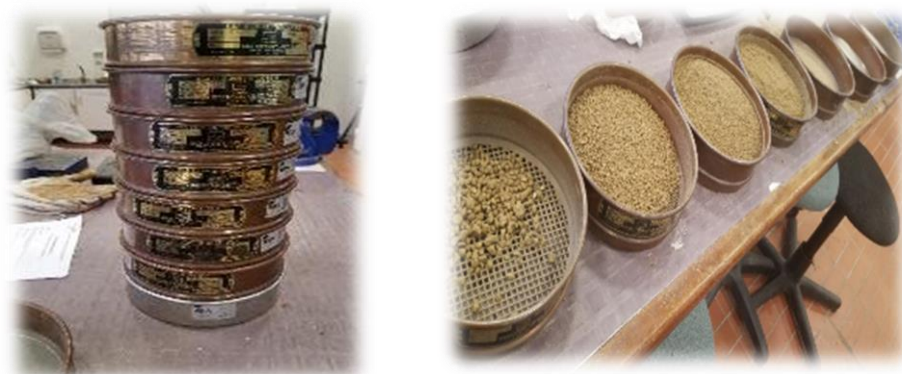
Figura 7. Tamices para ensayo de granulometría
