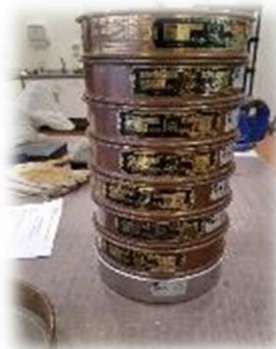
d). Tamices para ensayo de granulometría
