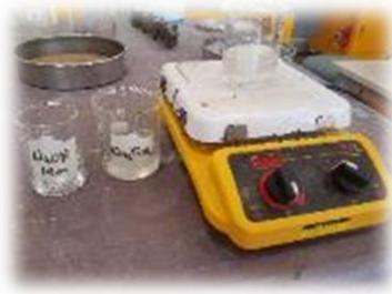
c). Agitador magnético para homogenizar la mezcla alcalina
