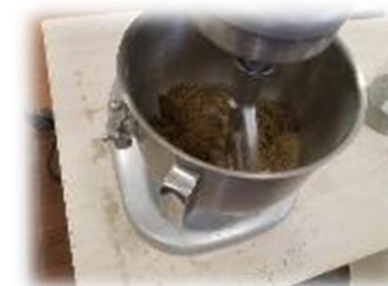
f). Mezcla de Sln. Alcalina y arena
