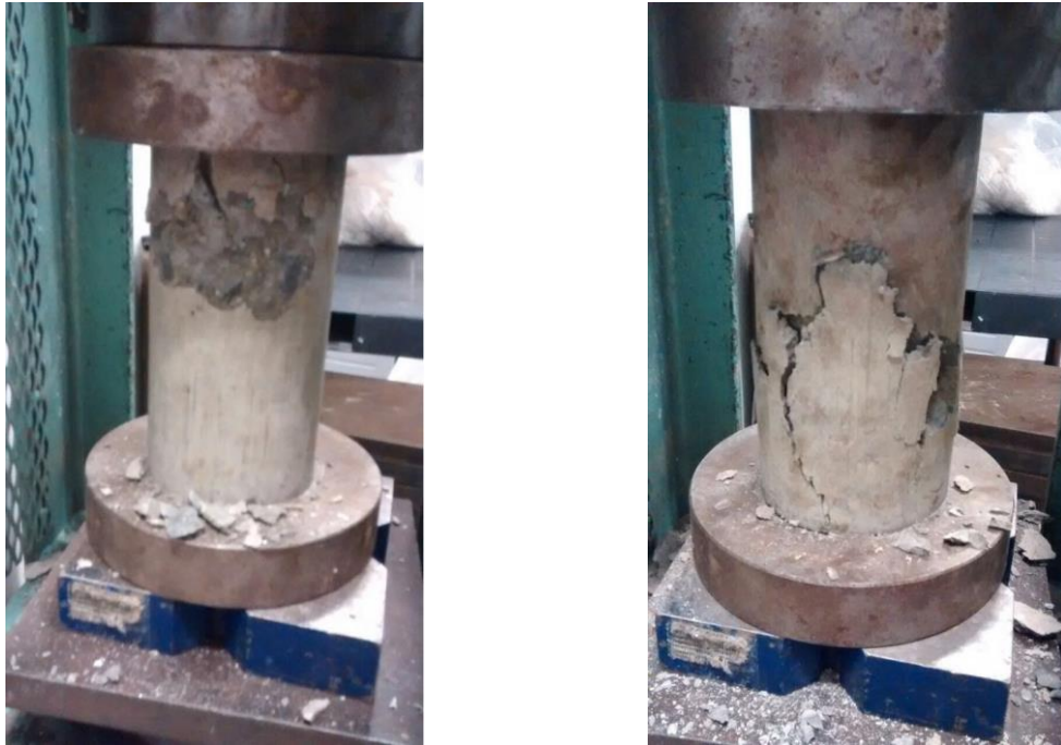
Figura 13. Falla de cilindros de concreto.
