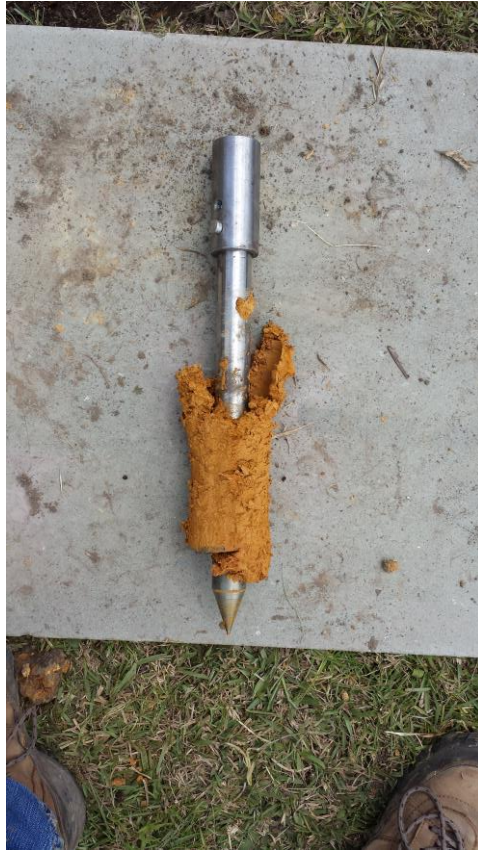
Ilustración 1. Adhesión del suelo a la pila después de un ensayo a tracción. Elaboración propia
