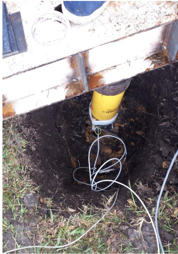
Figura 34. Montaje para ensayo a compresión. Elaboración propia
