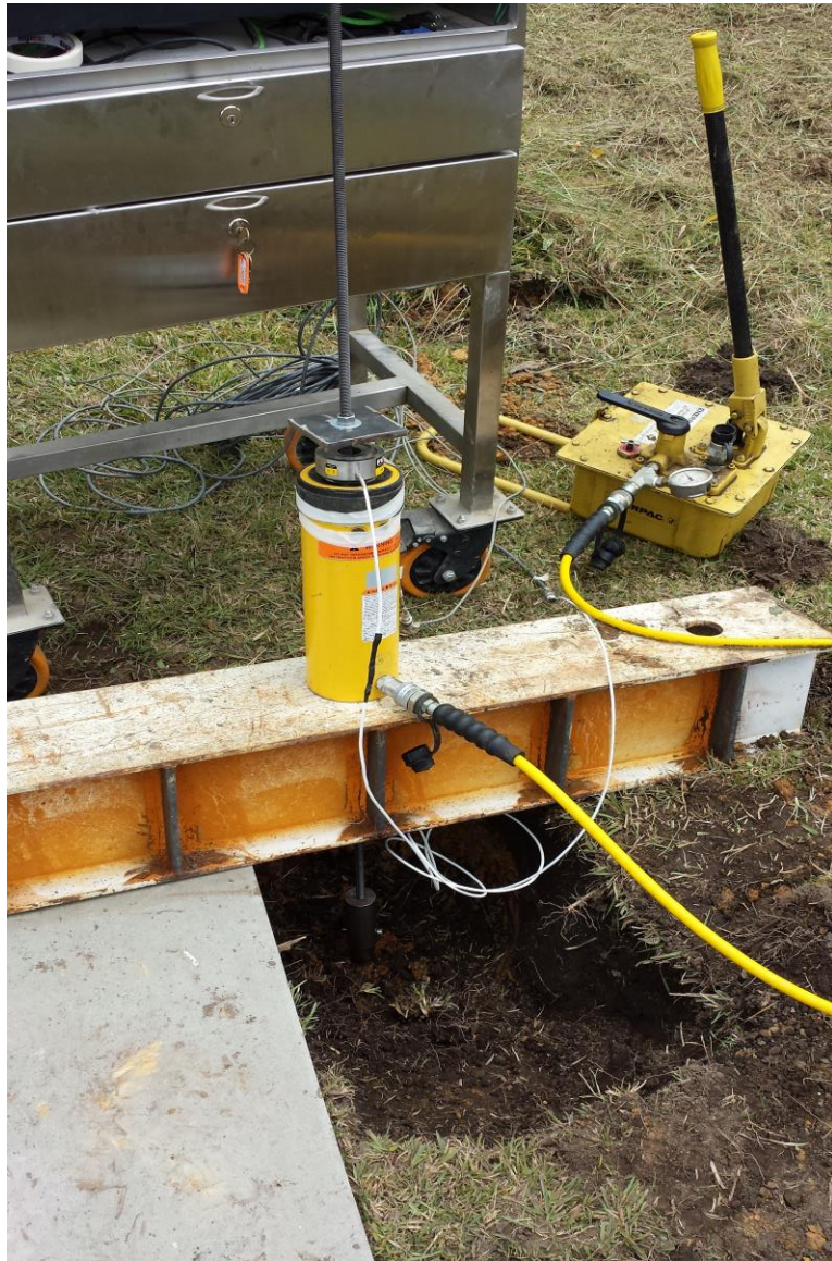
Figura 31. Montaje para ensayo a tracción. Elaboración propia
