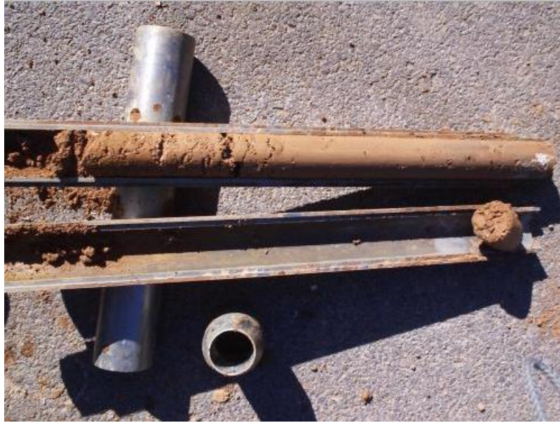
Figura 11. Muestra de suelo en tubo Shelby. Tomada de: http://www.sondgea.com/arxius/imatges/activitats/sondejos/mostres-1.jpg
