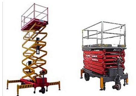
Ilustración 6. Plataforma para trabajo en altura
