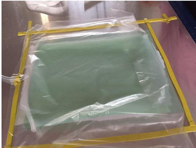
Ilustración 25. Montaje de lámina para primer acercamiento con proceso VARTM.
