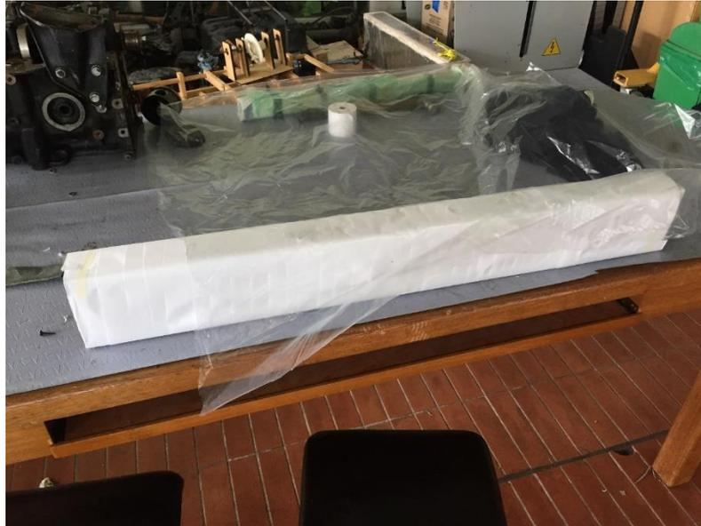
**Ilustración 29. Molde de acero envuelto en papel bond para facilitar desmoldeo.**
