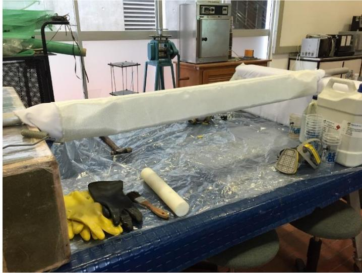
**Ilustración 31. Molde listo para impregnación. Primera construcción por moldeo manual.**
