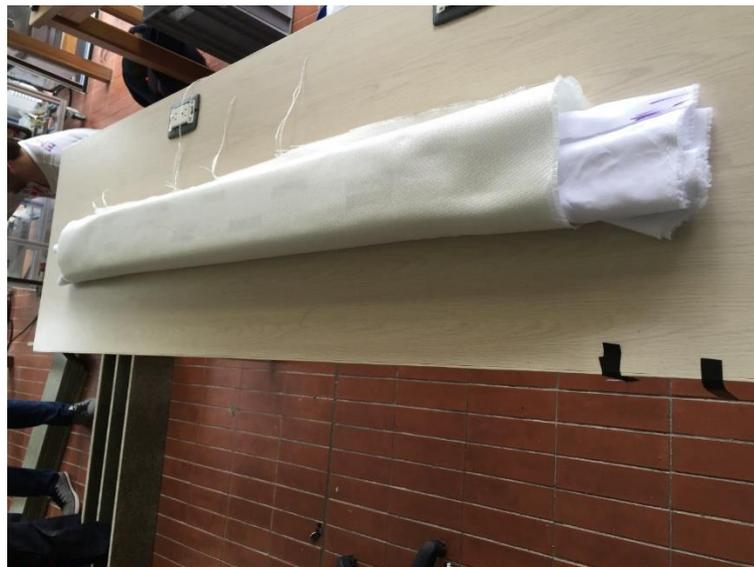
**Ilustración 30. Proceso previo a impregnación con resina. Molde envuelto en capas de refuerzo.**
