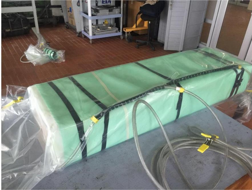
**Ilustración 27. Molde de madera, con tres entradas de resina.**
