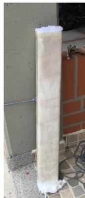
**Ilustración 32. Primera viga construida mediante moldeo manual.**
