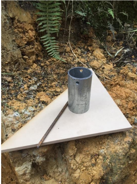
Figura 30 Molde para determinar la densidad del suelo Fuente: creación propia
