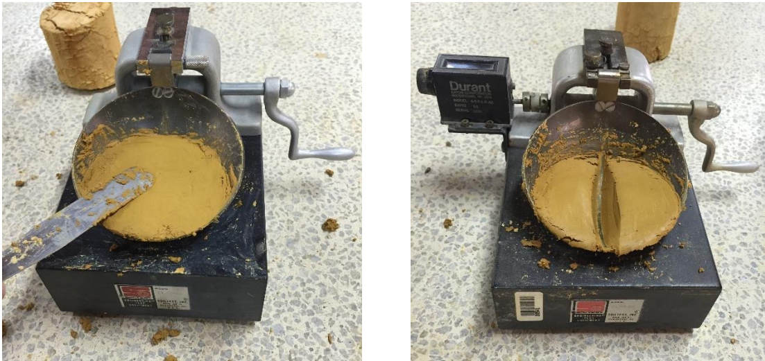
Figura 27 Procedimiento ensayo límite líquido
