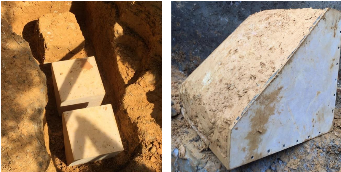
Figura 35 Extracción y moldeo del talud
