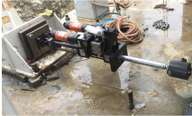
Figura 33 Instalación del actuador dinámico
