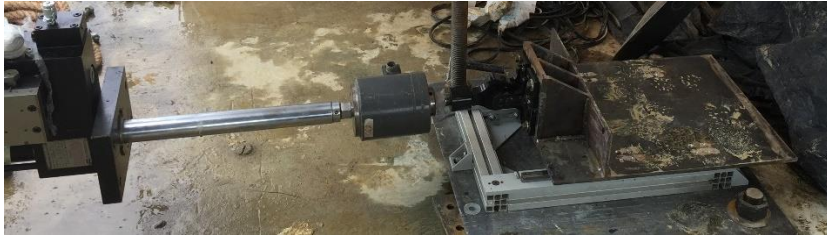
Figura 34 Acople entre actuador dinámico y estructura vibratoria
