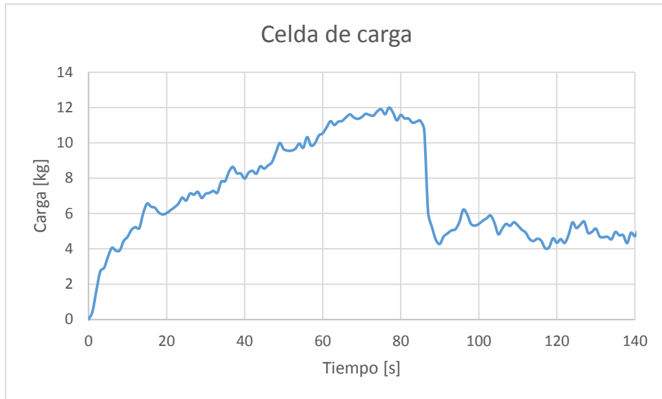
Figura 3.36 Lectura de carga lateral en la pila, ensayo 2
