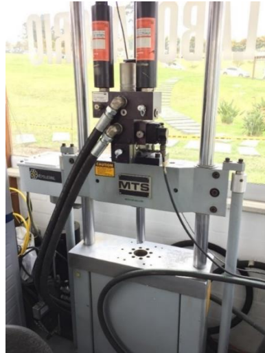
Figura 3.18 Prensa hidráulica utilizada para los ensayos de carga vertical
