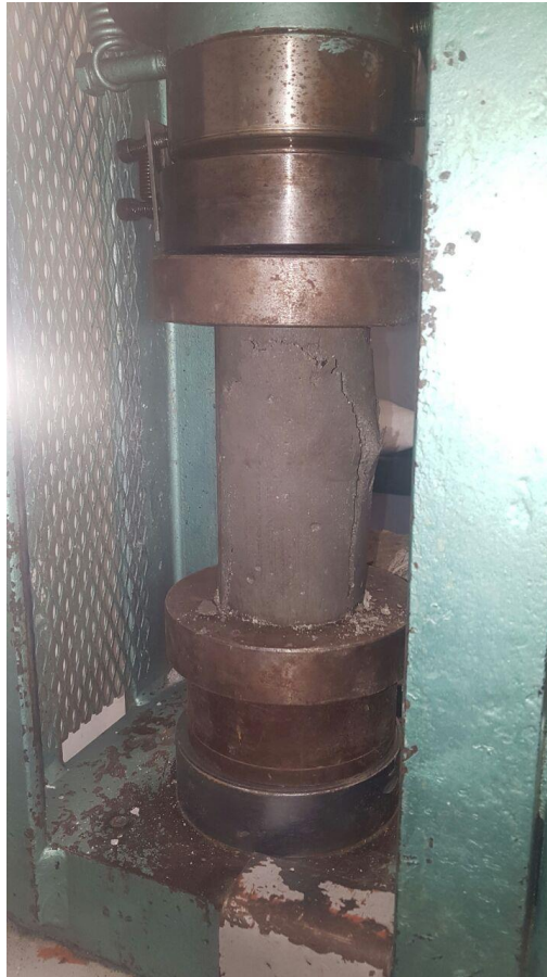
Figura 3.9 Falla de cilindro. Fuente: creación propia
