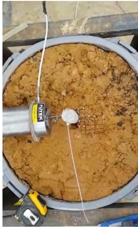
Figura 3.30 Montaje de ensayo de carga lateral
