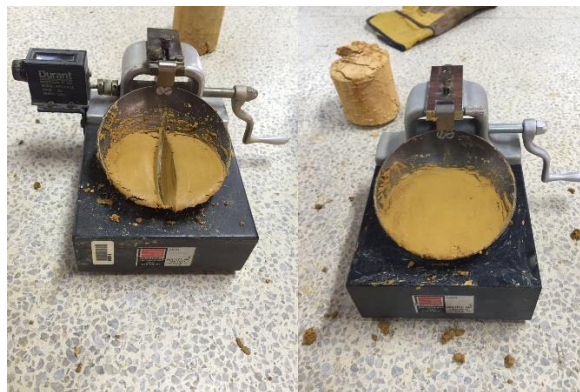
Figura 3.2 Ensayo de límites. Cortesía de Omar Stiven Ríos
