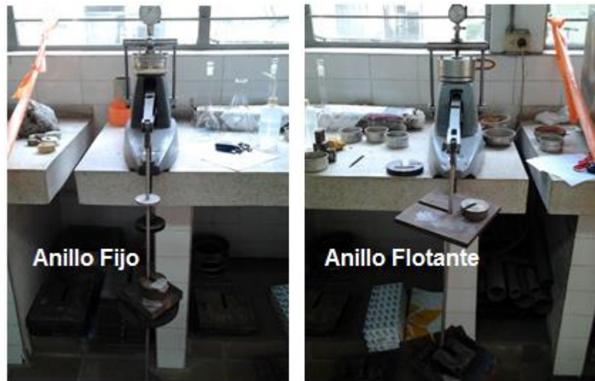
Ilustración 10: Equipo de consolidación de anillo fijo y anillo flotante EIA. (Foto tomada en el laboratorio de suelos de la EIA)
