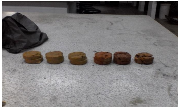
Ilustración 37: Plano de falla muestras ensayo de corte. (Foto tomada en el laboratorio de suelos de la E.I.A)
