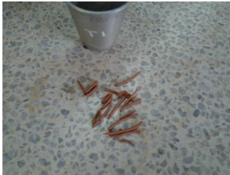
Ilustración 33: Ensayo de límite plástico. (Foto tomada en el laboratorio de suelos de la E.I.A)
