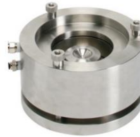
Ilustración 8: Celdas de consolidación Anillo fijo y Anillo flotante (HUMBOLDT, 2010)
