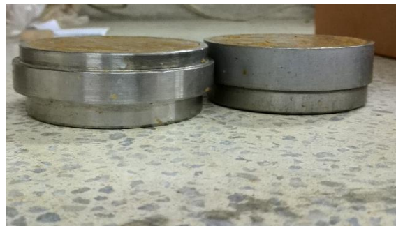
Ilustración 35: Muestras en anillo de corte. (Foto tomada en el laboratorio de suelos de la E.I.A)
