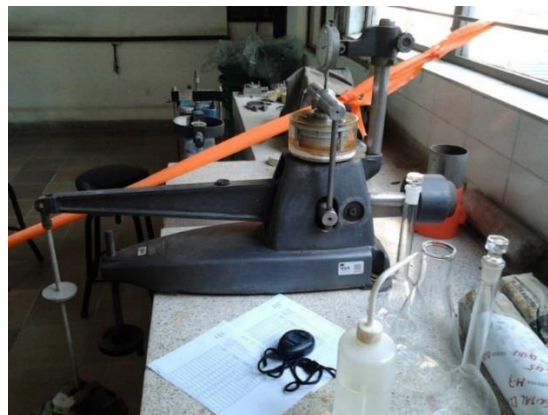
Ilustración 31: Ensayo de consolidación anillo fijo
