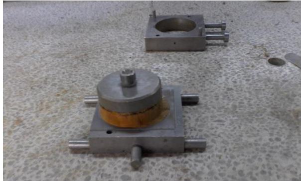
Ilustración 36: Muestra fallada ensayo de corte directo. (Foto tomada en el laboratorio de suelos de la E.I.A)
