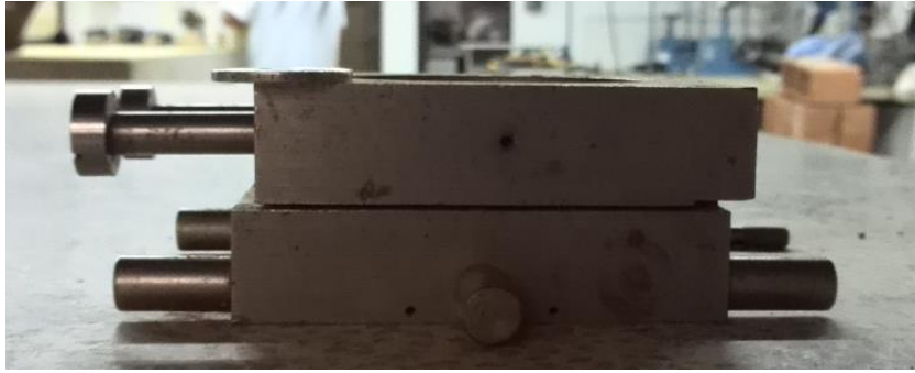
Ilustración 22: Caja de Corte Directo. (Foto tomada del laboratorio de suelos de la EIA)
