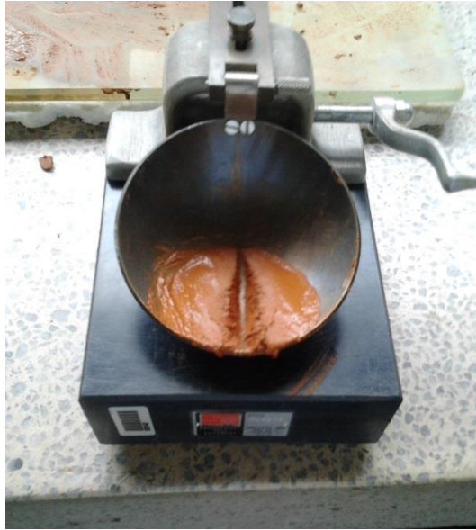
Ilustración 34: Ensayo de límite líquido, copa de Casagrande. (Foto tomada en el laboratorio de suelos de la E.I.A)
