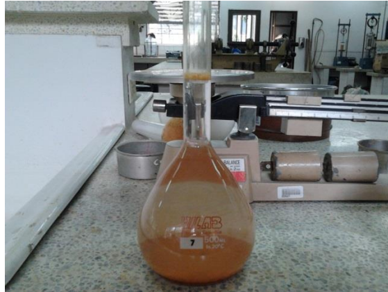
Ilustración 32: Ensayo de gravedad específica con picnómetro. (Foto tomada en el laboratorio de suelos de la E.I.A)
