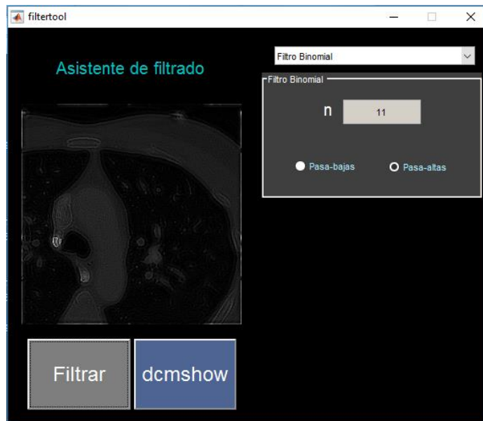
Figura 23 Herramienta de filtrado luego de ejecutar filtrado binomial pasa altas de orden 11.
