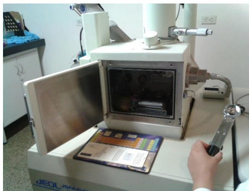
Ilustración 9. Posicionamiento y evaluación de las muestras de cada tratamiento en el equipo SEM
