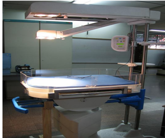
Fig. 2. Dispositivos de cuidado en pacientes críticos. Incubadora automatizada para neonatos desarrollada por el Grupo de Bioingeniería (Universidad Pontificia Bolivariana).
