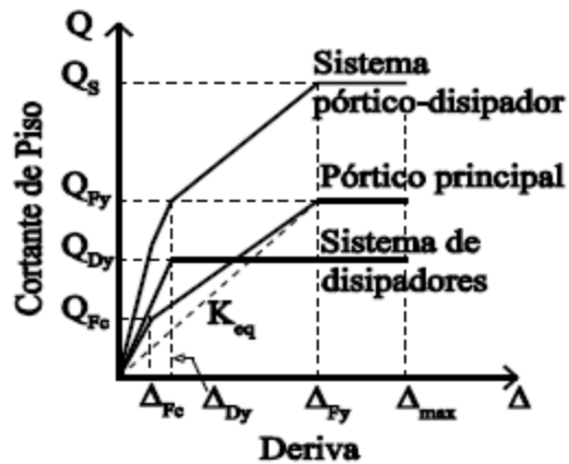
Figura 4. Curva idealizada de Cortante vs. Deriva para un sistema pórtico-disipador. Imagen tomada de: (Oviedo A., Midorikawa, & Asari, 2011, pág. 4)
