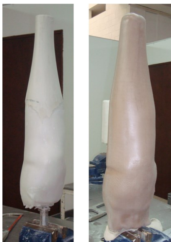
Figura 15. Molde de la pierna completa en yeso (izquierda) y parte externa de la prótesis (derecha)
