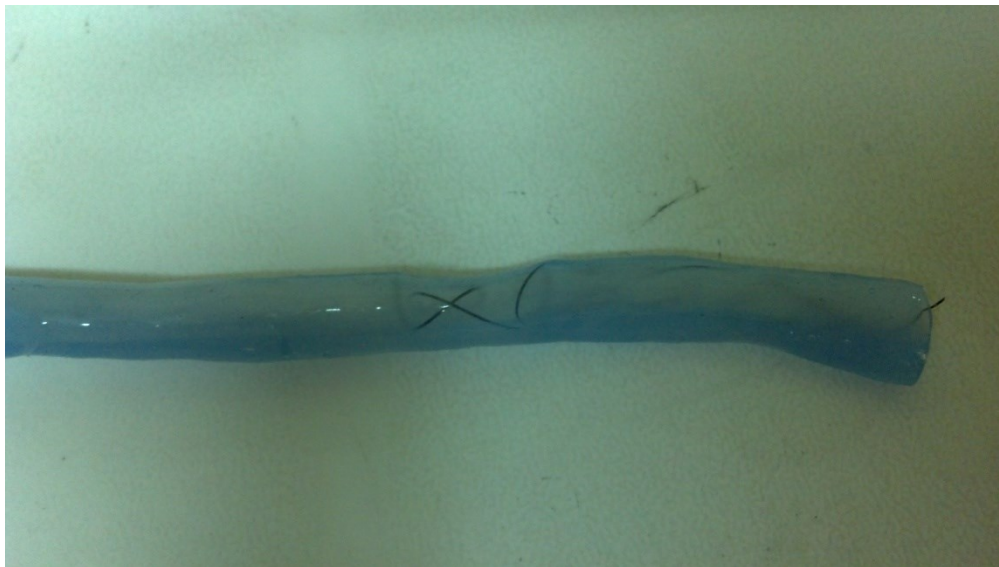
Figura 55. Stent insertado en modelo de arteria de silicona.
