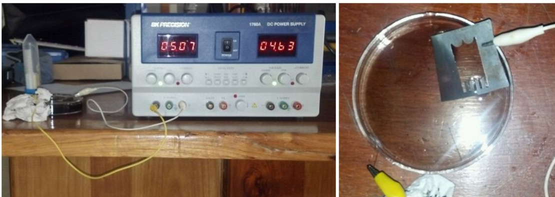
Figura 38. Prueba corrosiva a alambre control
