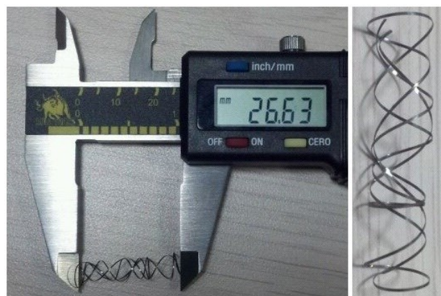
Figura 37. Prototipo de stent después del tratamiento térmico de recocido
