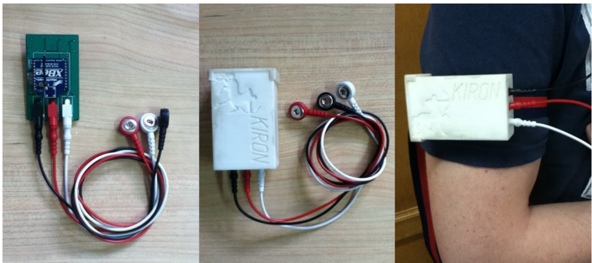
Figura 17 Dispositivo inalámbrico de adquisición para ECG.
