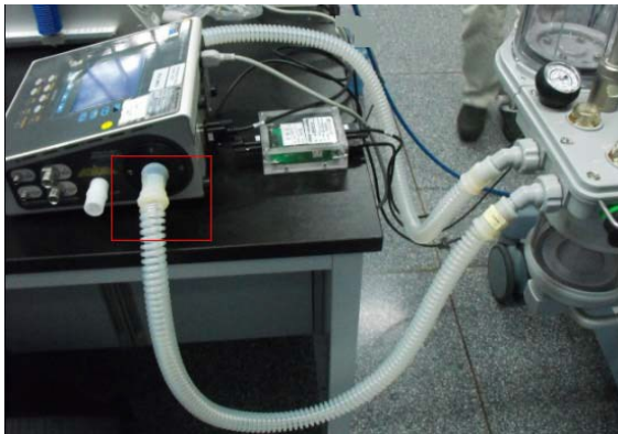
Figura 4. Proceso de verificación de alto flujo para máquina de anestesia de Mindray.
