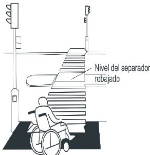
Figura 10. Cruce peatonal a nivel. (Tomado de (González, 2008))
