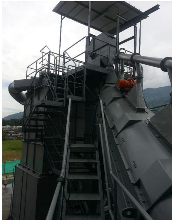
**Figura 37. Sistema de Manejo de carbón, zaranda y elevador corto (Gutiérrez & Lopera, 2013).**
