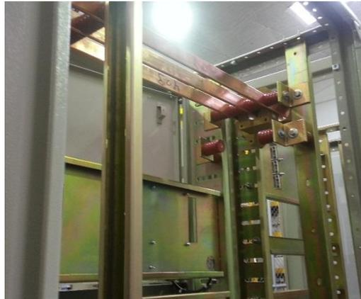
**Figura 15. Fabricación tablero MCC, Barrajes de Potencia (Gutiérrez & Lopera, 2013).**
