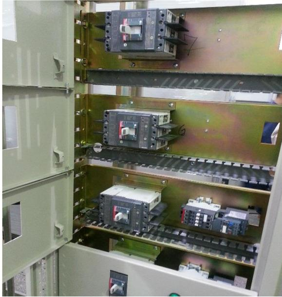
**Figura 16. Fabricación tablero MCC, compartimentos con protecciones para equipos (Gutiérrez & Lopera, 2013).**
