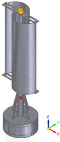
Ilustración 93. Sistema completo del aerogenerador, con muestra del sentido del eje coordinado y centro de volumen.
