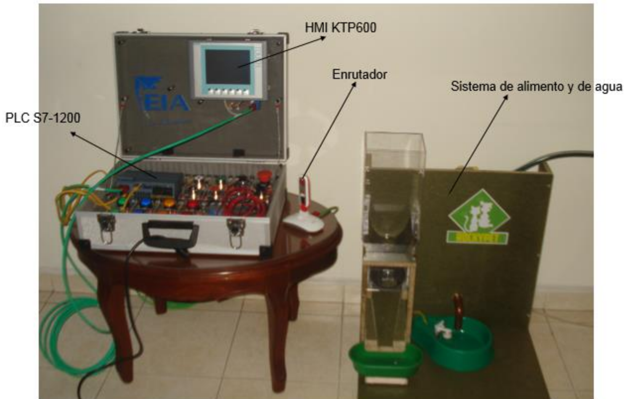
Ilustración 43. Sistema completo controlado inalámbricamente vía web.
