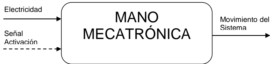
Figura 9 Caja negra de la mano mecatrónica.
