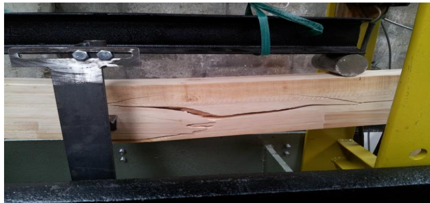
Ilustración 18 Falla de la madera a flexión
