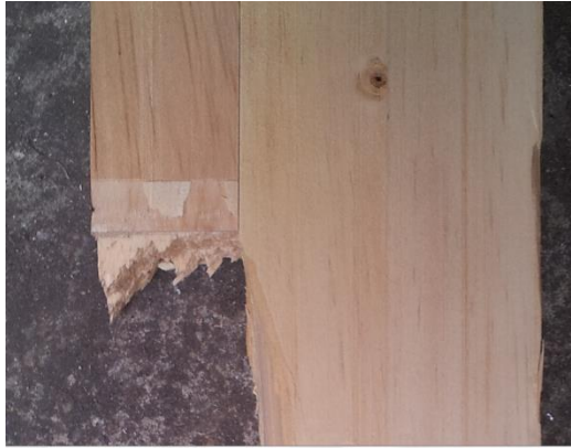
Ilustración 19 Falla por diferencia de densidad en la madera
