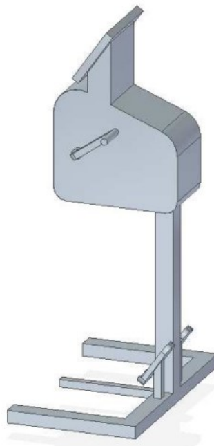
Fig. 28 Diseño Ergómetro de manivela o de brazos para usuarios en silla de ruedas.
