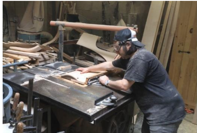
ILUSTRACIÓN II.6—45. CORTE EN EL CROSS CUT
