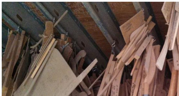
ILUSTRACIÓN II.6—5 FORMA ANTIGUA DE COLGAR TEMPLATES: CUERDA CON UN GANCHO COLGADOS A LAS VIGAS
