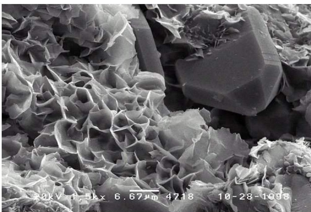
Figura 2.5. Imagen de microscopio electrónico de barrido (SEM) de una muestra de arenisca mostrando cristales de montmorillonita y de cuarzo (parte superior derecha) donde se observa la diferencia de área superficial entre ambos minerales. Tamaño de la imagen: 67 µm. Imagen tomada de <http://webmineral.com/data/Montmorillonite.shtml> (último acceso:29/03/2018).
