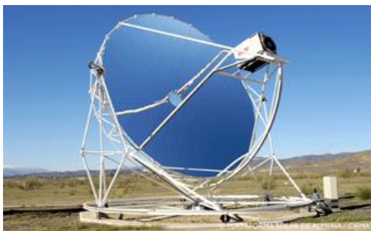
Figura 2.12. Concentrador disco Stirling Eurodish en la PSA (18)
