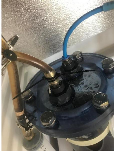
Ilustración 13: Detalle de los orificios sellados del digestor. Elaboración propia.
