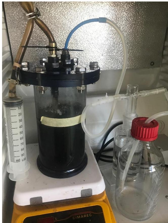
*Ilustración 12: Digestor sobre placa agitadora en el interior del calentador, junto con trampa de agua, botella de recolección de agua y jeringa de alimentación. Elaboración propia.*
