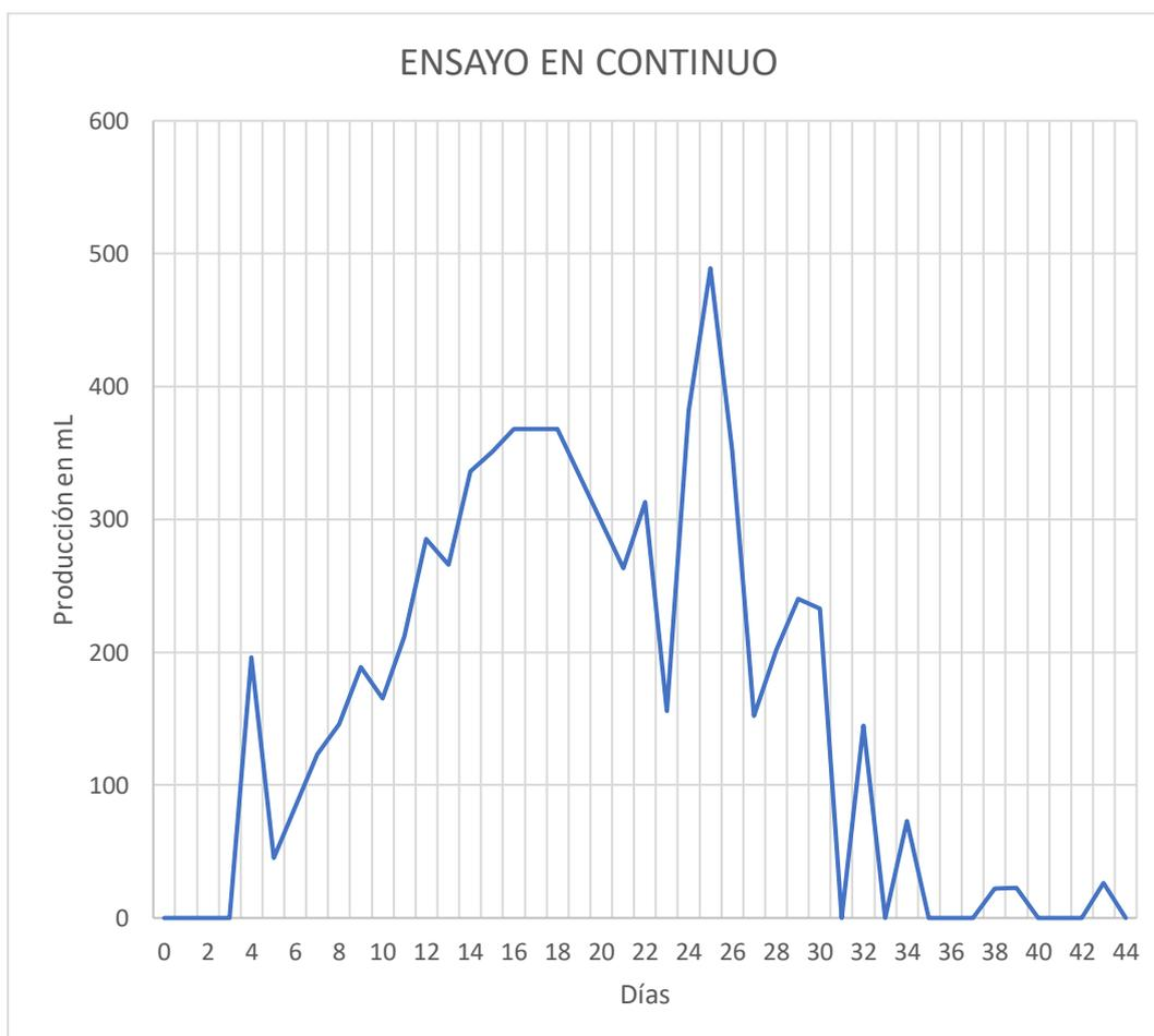
Gráfica 5: Producción Diaria de biogás en ml tras descontar los valores medios del Control en ensayo continuo. Elaboración propia.
