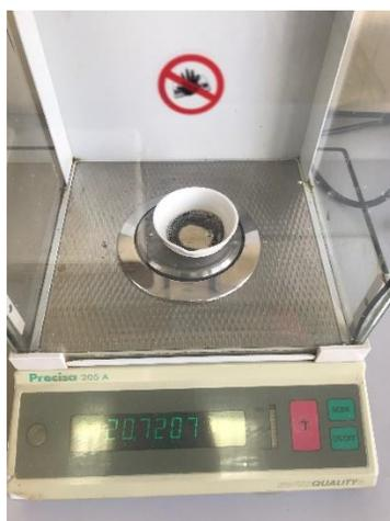
*Ilustración 7: Pesaje de ST del del lixiviado*
