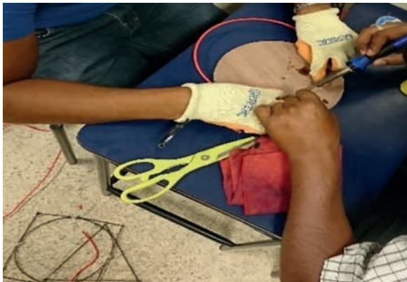
Figura 6. Unión de la malla circular con estaño
