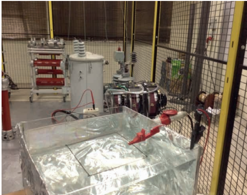
Figura 8. Pruebas de puesta a tierra sin electrolito
