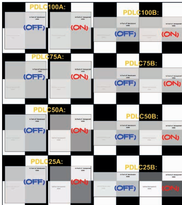
Figura 14. Simulación de la apariencia visual para la transmitancia total de los estados Off y On de dispositivos PDLC-A y PDLC-B
