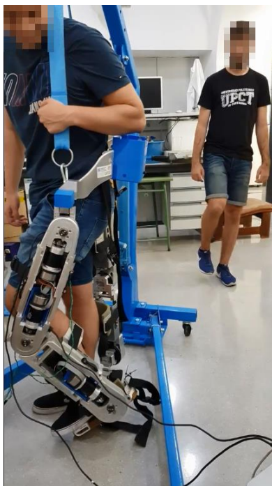
Figura 85. Prueba del sistema global. Rehabilitador situado al fondo a la derecha, donde sus movimientos son capturados por un sensor RGBD y transmitidos al exoesqueleto que porta el paciente
