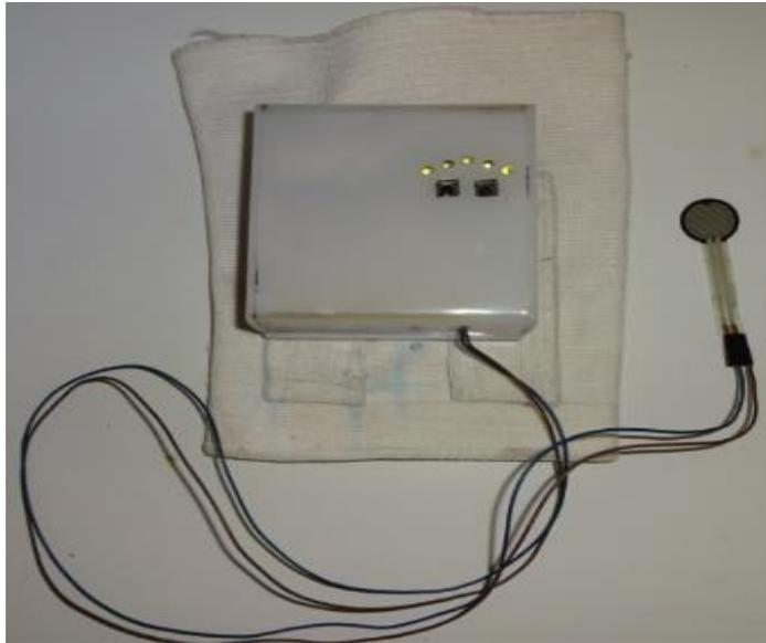
Figura N° 4.13: Prototipo implementado con su modo de sujeción
