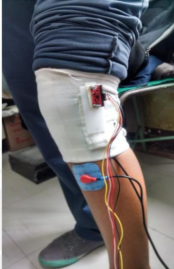
Figura N° A.1: Posicionamiento del módulo de sensor inercial
