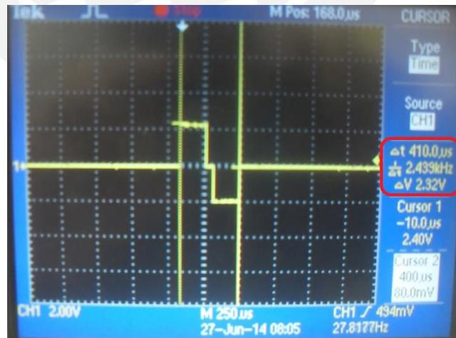
Figura Nº 4.10: Duración del pulso bifásico compensado simétrico.
