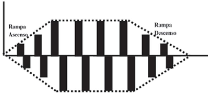
Figura Nº 2.8: Tren de pulsos rectangulares bifásicos simétricos con modulación.
