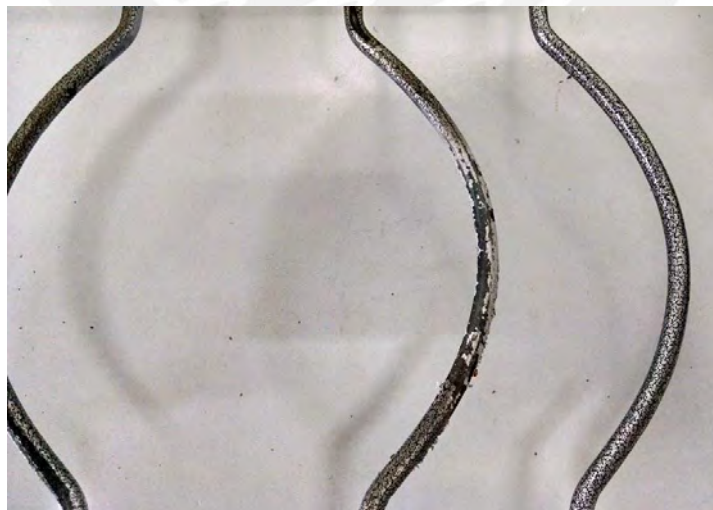
Figura 5.2 Desprendimiento de la pintura de la parrilla luego del primer uso.
