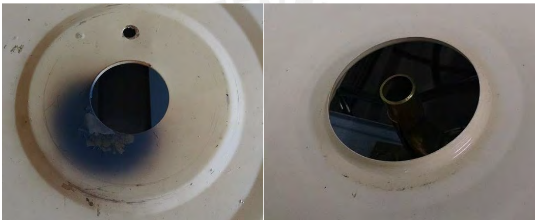
Figura 5.1 Deterioro de la pintura luego del primer uso.
