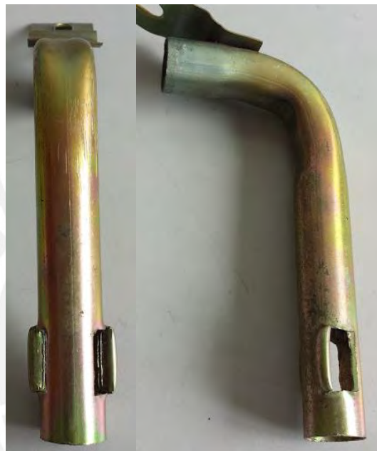
Figura 2.25 Mezclador original de las cocinas tipo anafe nacionales
