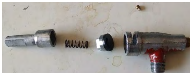
Figura 2.16 Explosión de válvula de quemador. Fuente: Elaboración propia
