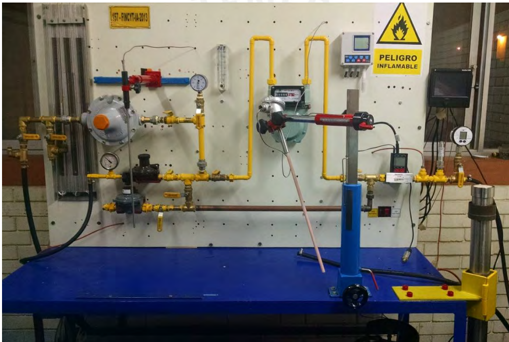
Figura 1.6 banco de ensayos
