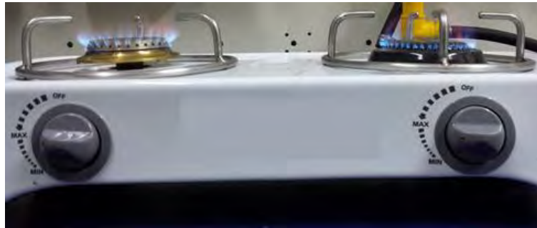
Figura 2.7 Efecto de las parrillas propuestas sobre la llama del quemador.
