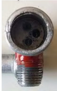
Figura 2.17 Mecanismo de reducción de flujo del gas. Fuente: Elaboración propia
