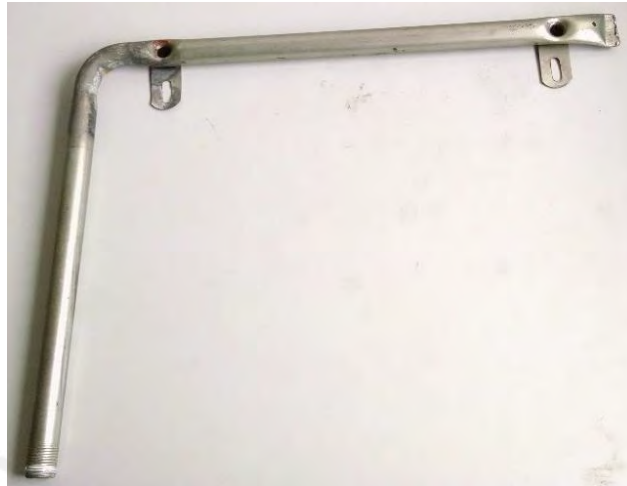
Figura 2.43 Tubería de distribución de gas. Fuente: Elaboración propia
