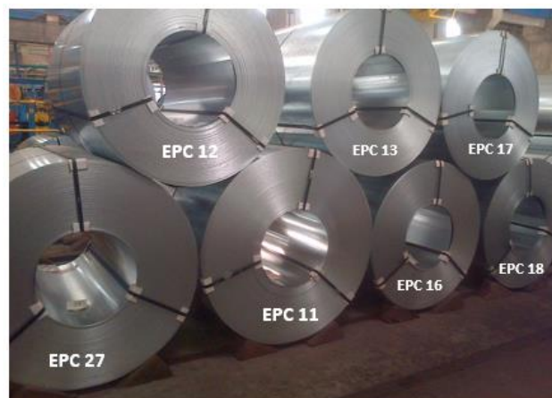
Figura 3. Pirámide de rollos estáticos interferentes en la identificación del producto metálico en movimiento transportado por el montacargas en el portal construido.
