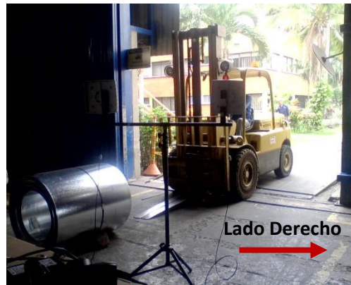
Figura 2. Configuración del sistema RFID pasivo UHF tipo portal en ACESCO S.A.
