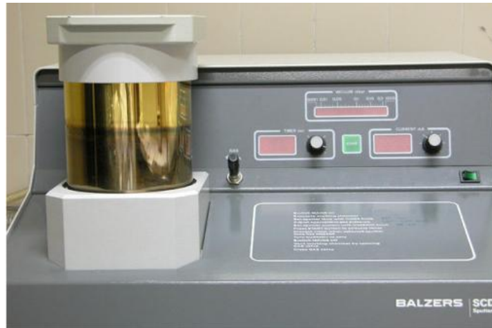
Figura 5.3. Equipo de pulverización catódica usado para la capa semitransparente de oro.
