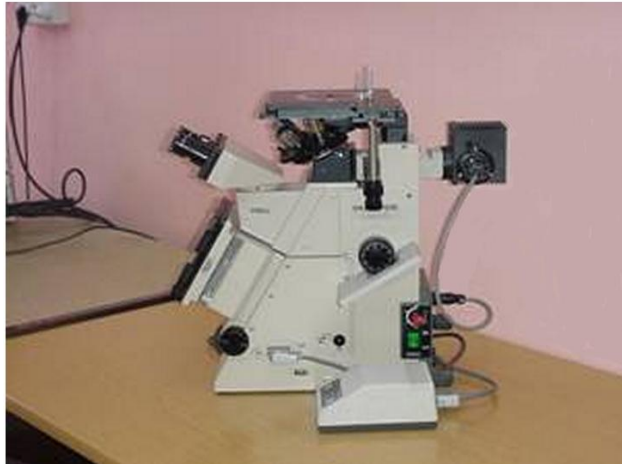
Figura 5.4 Microscopio óptico de reflexión usado para caracterizar las muestras de silicio multicristalino.
