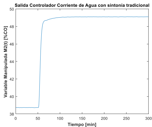
Figura 52 Comportamiento variable manipulada 2 con sintonía tradicional ante una perturbación de +10% en la concentración del reactivo A
