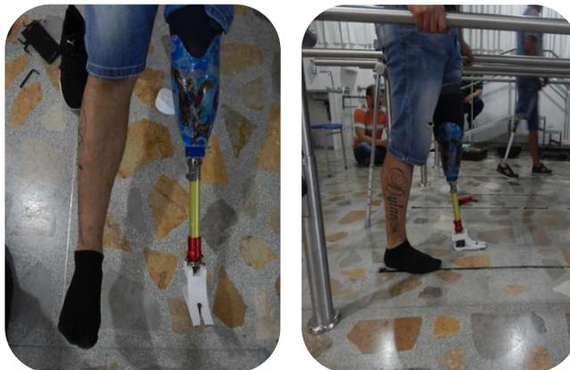
**Figura 5.26.** Prueba del pie protésico con ayuda de una persona con amputación transtibial
