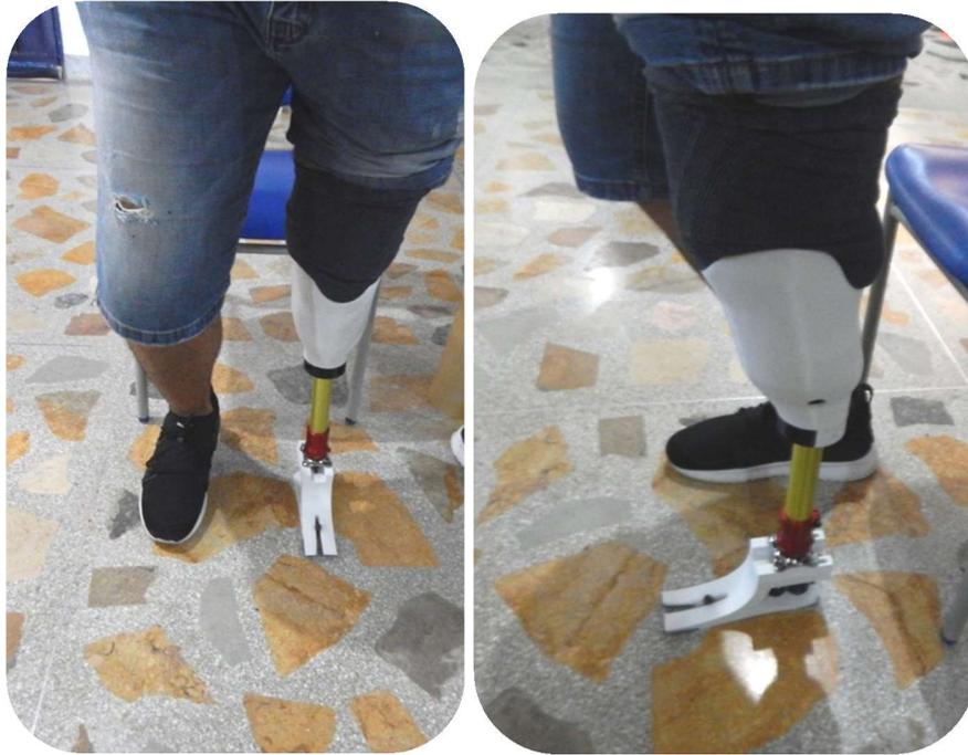
**Figura 5.3.** Socket protésico transtibial en pruebas con el usuario. La impresión tardó alrededor de 5 horas.
