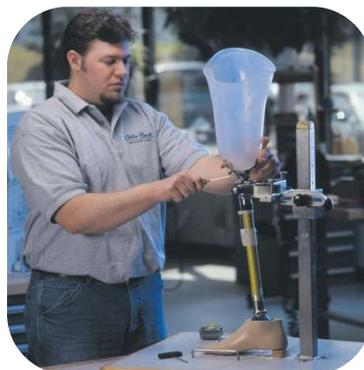
**Figura 2.13.** Alineamiento estático de una prótesis transfemoral. Imagen cortesía de Ottobock LP.
