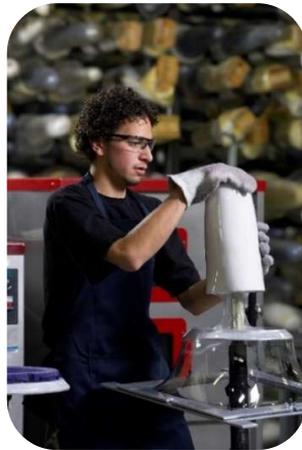
Figura 2.15. Plastificado de socket protésico. Imagen cortesía de Ottobock LP.
