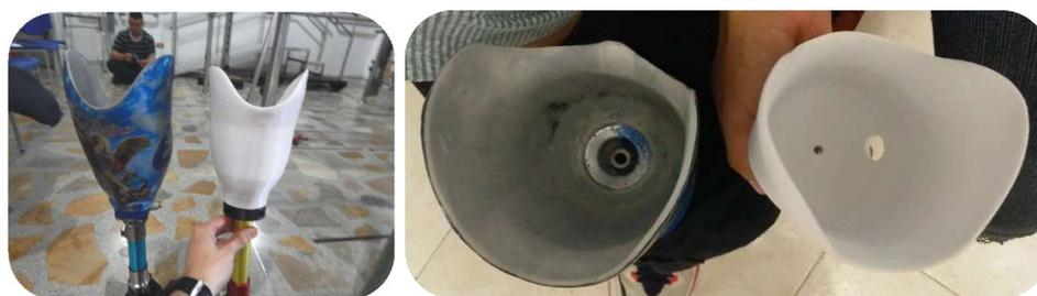
Figura 6.1. Vista frontal y superior de socket protésico actual (izquierda) y fabricado (derecha).
