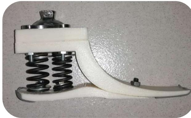
Figura 5.24. Prototipo pie protésico en plástico ABS
