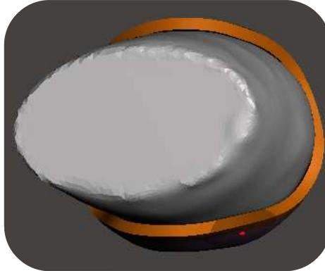
Luego cambiar a la opción de filtro a 'Geodesic distance' y manteniendo la tecla 'Ctrl', moviendo la rueda del mouse (botón central) para seleccionar los triángulos de la superficie del socket que se modificarán.
