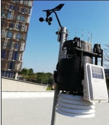
Figura 4.4 Estación meteorológica
