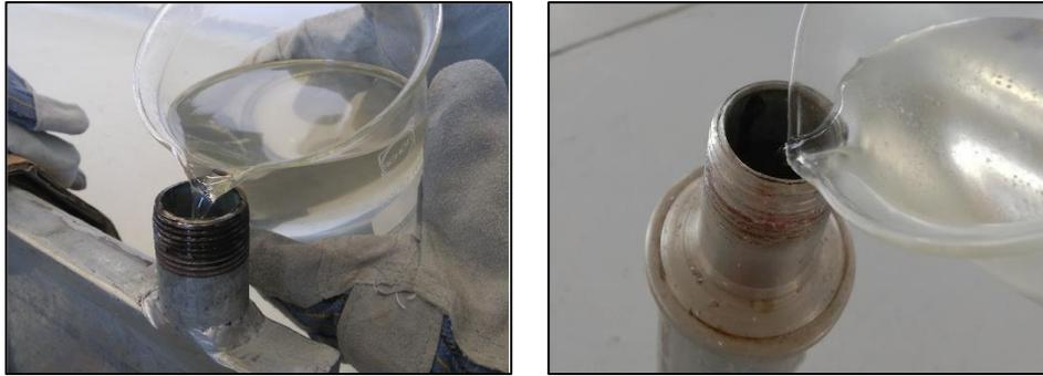
4.3a. Llenado de PCM de los contenedores del colector (Izq.) y contenedores del tanque (Der.)
