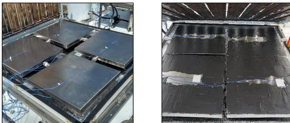
Figura 4.8 Contenedores sin pasta térmica (Izquierda) y con pasta térmica (Derecha)
