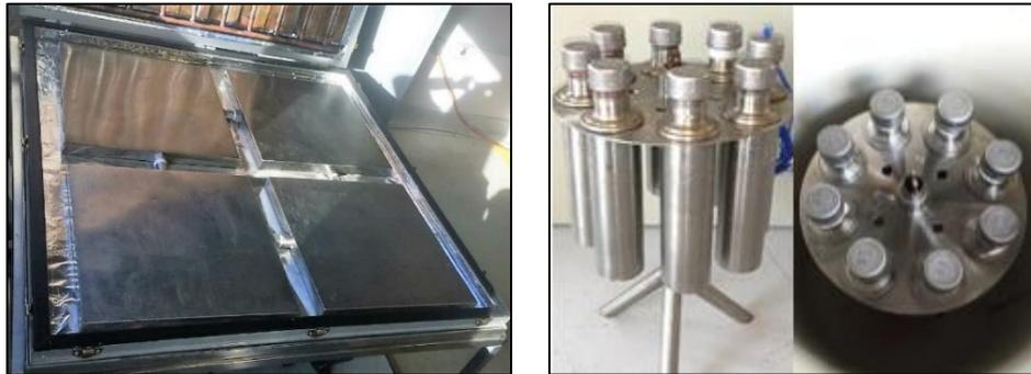
4.3b. Ubicación de contenedores de PCM en el colector (Izq.) y el tanque (Der.)
