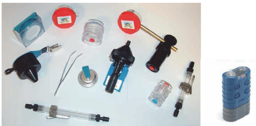
Figura 15. Equipos para medición con bomba de muestreo. Fuente: (Higuero et al. 2016)
