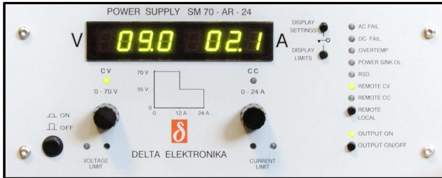
Figura 42: Vista frontal de la fuente de alimentación funcionando y dando la máxima potencia programada a la resistencia termocoax de  $4,3 \Omega$
