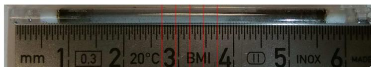
Figura 75: Fotografía del capilar de zafiro relleno de muestra, con las juntas de PTFE (piezas cilíndricas blancas) y una indicación de las posiciones de toma de datos.
