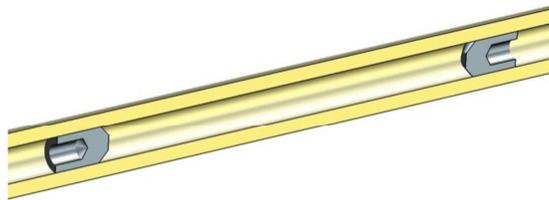
Figura 19: Sección del capilar donde se observan las juntas de PTFE para aislar la muestra
