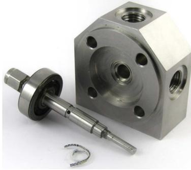
Figura 48: Fotografía de la junta FLEXISEAL dañada tras desensamblar la celda
