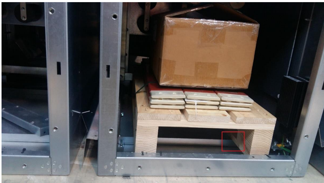
Figura 29- Teste inicial à Mini-Palette (Palette a deformar as chapas interiores)
