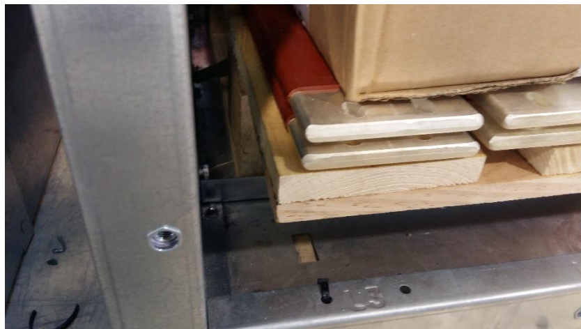
Figura 32- Base da Mini-Palette inserida entre chapas
