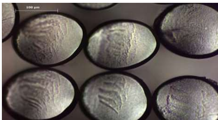
Figura 8: Fibra produzida por fiação por fusão, com geometria bainha-núcleo. O núcleo é composto por PP, 70% da fibra, e a parte externa (a preto na imagem), é composta por 30% de PET.
