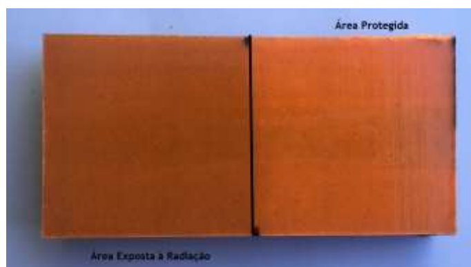
Figura 22: Imagem obtida após o ensaio de envelhecimento. Amostra com EVA como polímero base e FLUO1 com aditivo adicionado, ao substrato de MDF.
