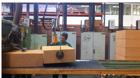
Figura 17 - Colocação de blocos na mesa de laminagem
