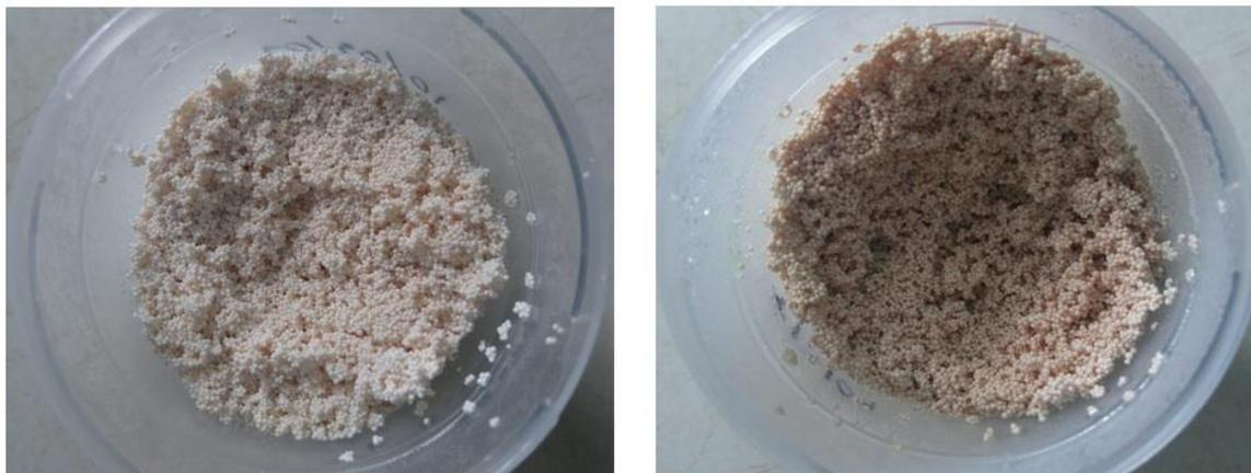
*Figura B.0.1 - Fotografias das resinas RA (à esquerda) e RB (à direita).*
