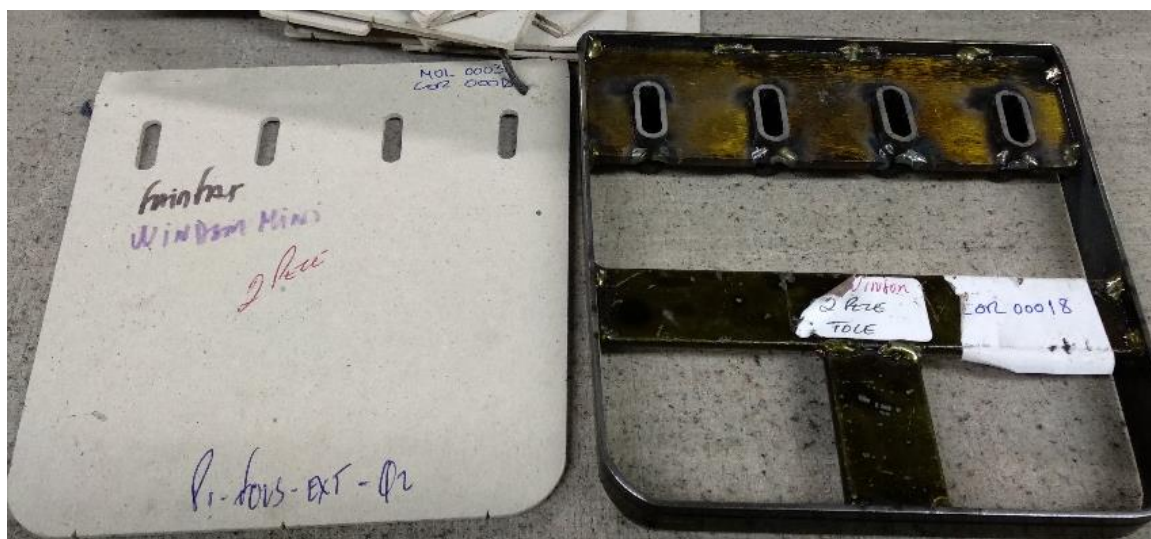
Figura 2 - Molde de corte em cartão (esquerda) e respetivo cortante (direita)
