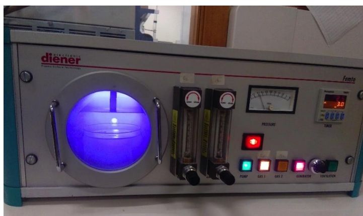
Figure 4.5 Plasma Generator Equipment (Departamento de Química da Universidade de Coimbra).
