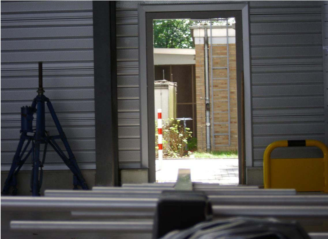
**Bild 4:** Antennenposition „Hinterausgang“ mit gerichteten LogPer Prüfantennen, Horizontal
