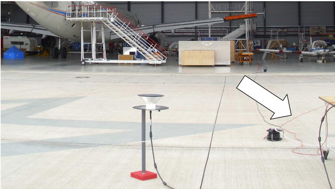
**Bild 1:** Antennenposition „geöffnetes Tor“ mit monokonischen Prüfantennen, Vertikal
