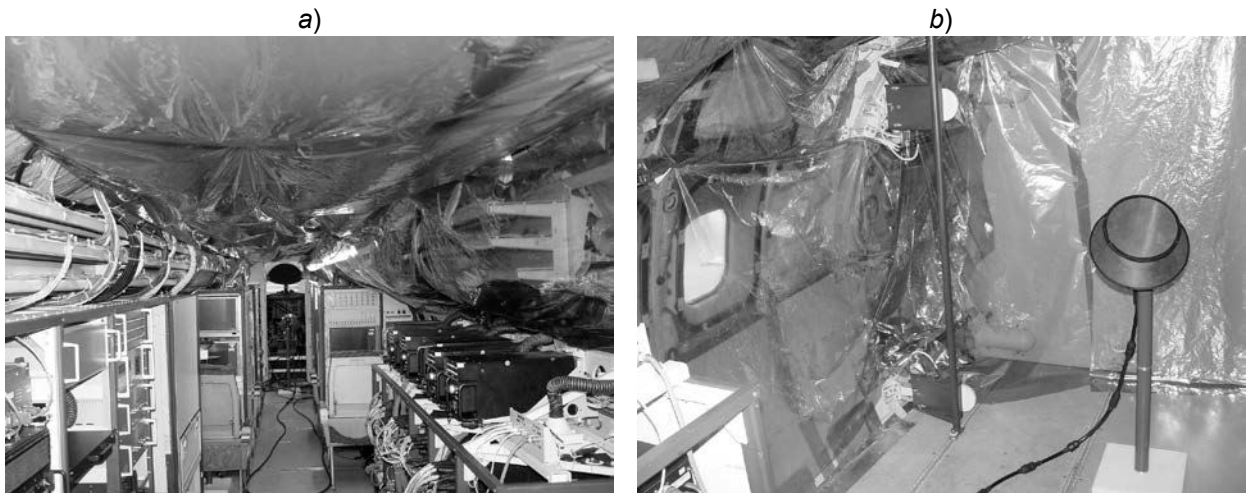
Bild 1: Absorberfolien a) an der Decke und b) vor dem Druckschott und an den Seitenwänden (inkl. hintere Flugzeugtür und Fenster) mit Sendeantenne im Vordergrund
