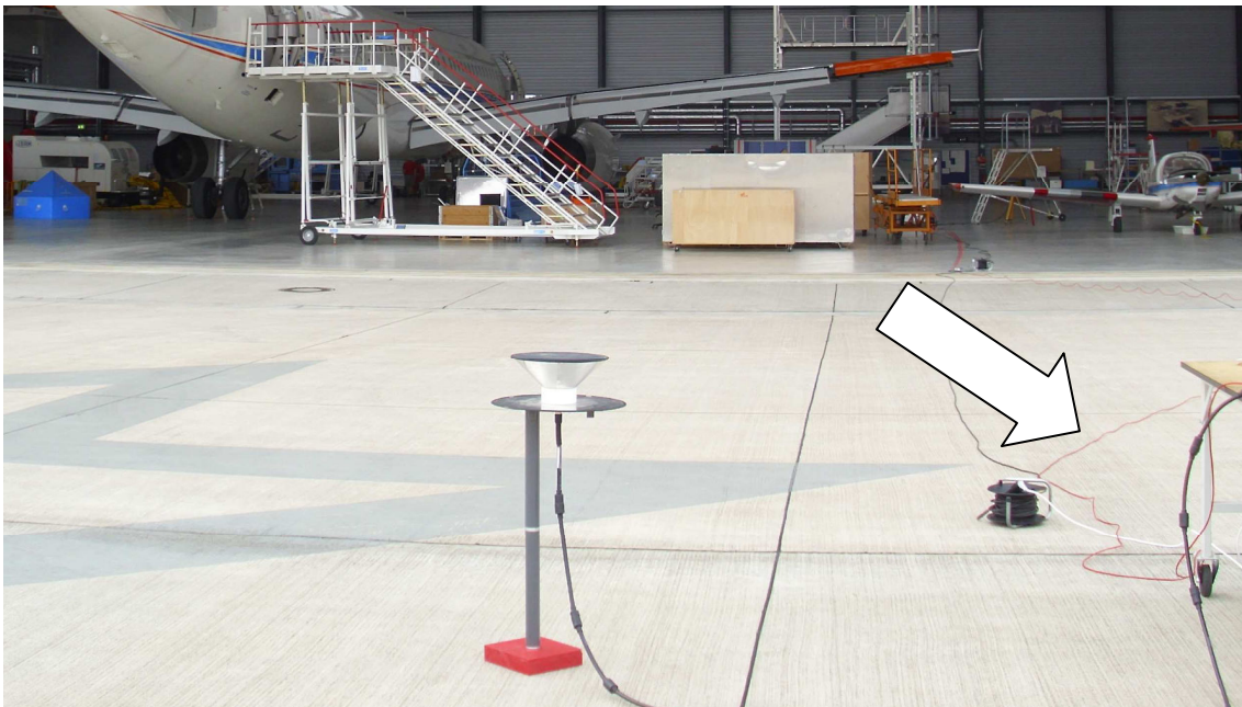
Bild 1: Antennenposition „geöffnetes Tor“ mit monokonischen Prüfantennen, Vertikal
