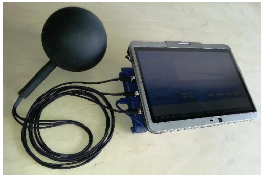
Bild 8: Messsystem für Störfeldmessungen mittels 3D-Searchcoils
