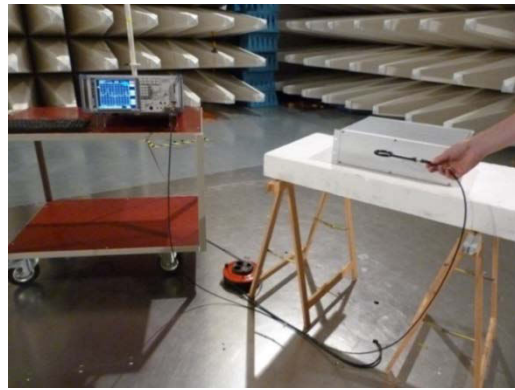
Abb. 6: Abstrahldiagramme (links) und Nahfeldmessaufbau (rechts) vom Prüfling „2“
