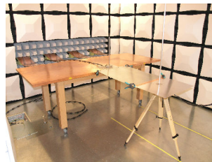
Bild 3.2.3: Messung RMM in einer ALSE Bild 3.2.3a: RMM Messanordnung in einer ALSE
