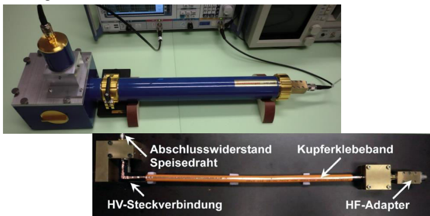
Bild 12: links: konfektionierte Leitung mit HV-Steckverbinder (ohne Kunststoffumhüllung) oben rechts: angepasster, triaxialer Messaufbau (Fa. Bedea) unten rechts: angepasstes Speisedrahtverfahren
