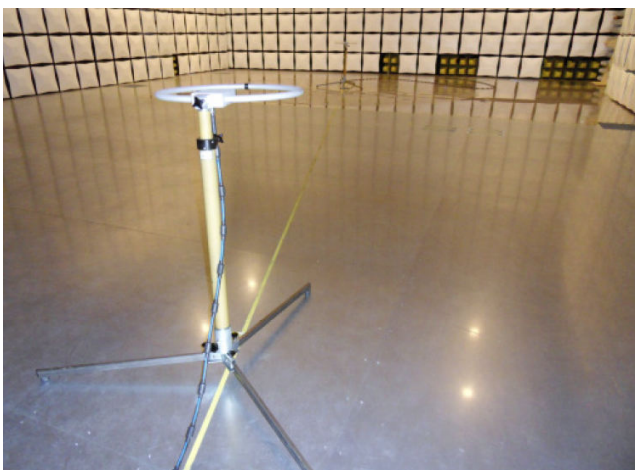
Bild 4.5a: Messung nach Set Up 3 in einer Absorberhalle mit Hybridabsorbern
