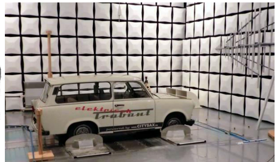
Bild 5: Störaussendung auf Fahrzeugebene (EMV-Halle WHZ)
