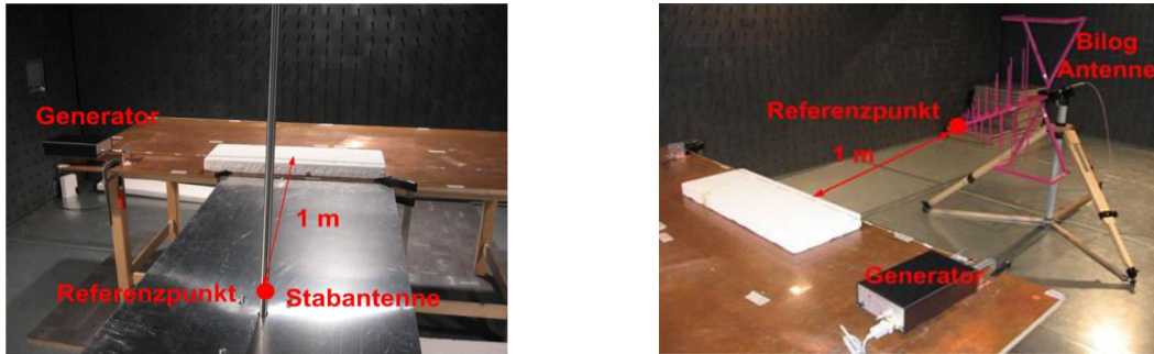
Abbildung 3: ALSE Testkonfiguration mit aktive Stabantenne (links) und Bilog Antenne (rechts)
