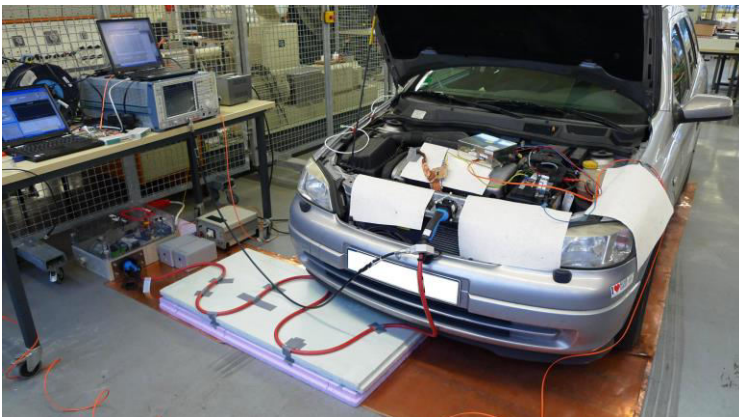
Abbildung 7: Messaufbau für Störstrommessung auf der Ladeleitung bei metallischem Untergrund
