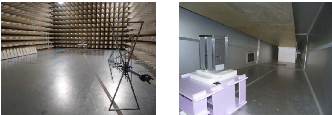
Abb. 2: Messaufbau für den Prüfling „1“ in der Absorberhalle (links) und in der GTEM-Zelle (rechts).
