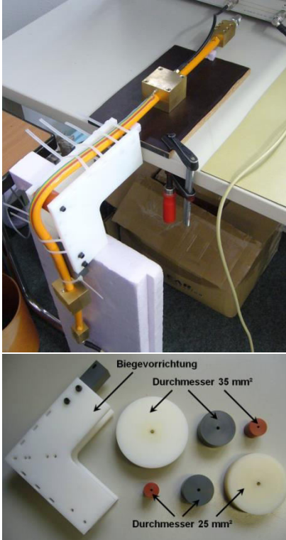
Bild 10: Messaufbau Speisedrahtverfahren für unterschiedliche Biegeradien der HV-Leitungen
