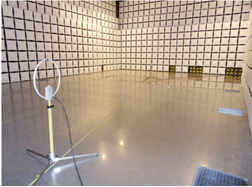
Bild 4.4a: Messung nach Set Up 2 in einer Absorberhalle mit Hybridabsorbern
