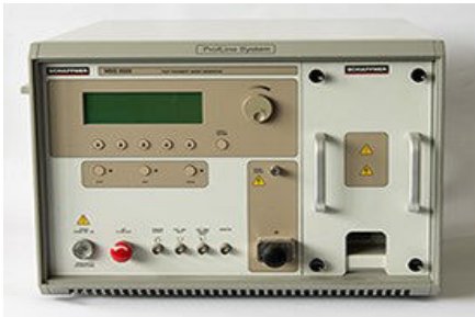
Bild 7: Burst Generator von Schaffner (links) zur Erzeugung des Störsignals (rechts)
