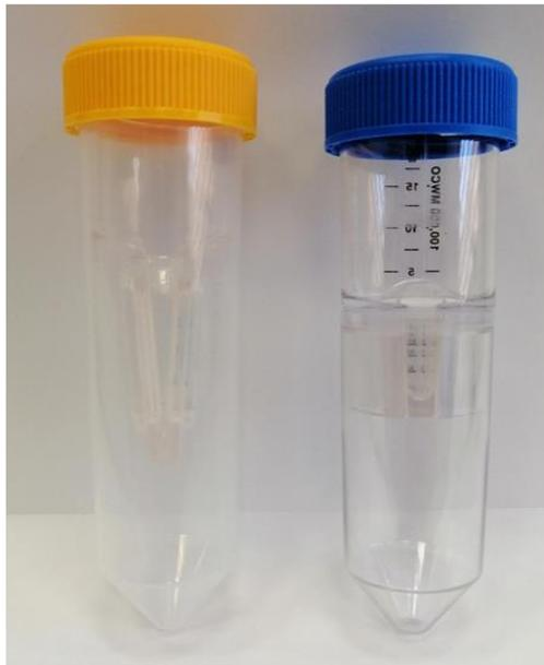
**Figura M.23.** a) Concentración por ultrafiltración, b) Tubos Vivaspin de ultrafiltración.
